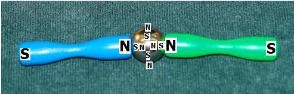
Rysunek 3. Pręciki magnetyczne zbliżone biegunami jednoimiennymi oraz indukowane pole magnetyczne w kulce.
