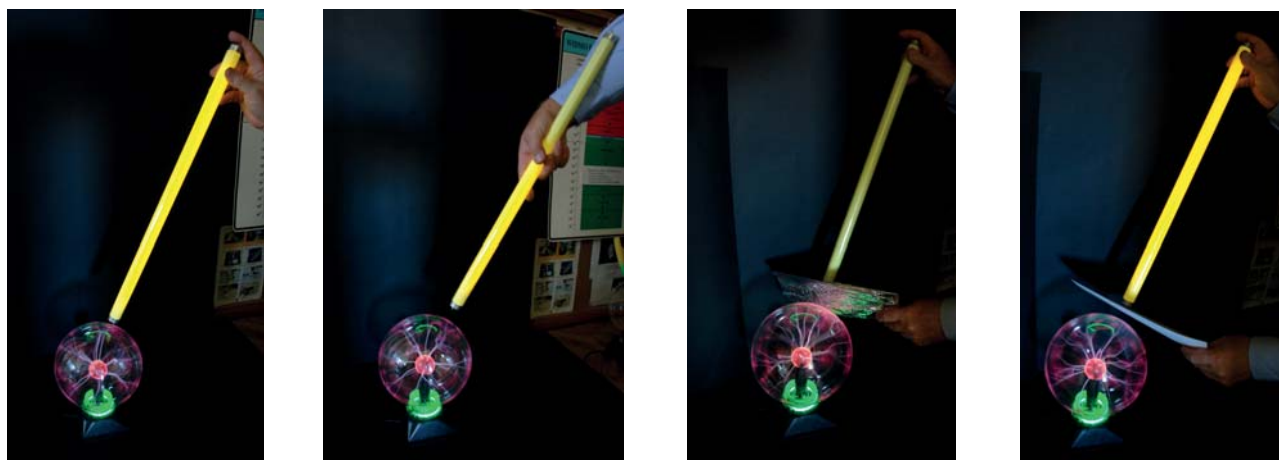
Foto 1. (a) Świetłówka (wymagająca zasilania z sieci elektrycznej) zapala się nawet nie dotykając kuli: „napięcie” na zewnątrz kuli to co najmniej 220 V (b) Wzdłuż świetłówki propaguje fala elektro-magnetyczna o dużej mocy – to ona zapala świetłówkę. (c) Falę można „ekranować” za pomocą cienkiej folii aluminiowej. (d) Przez kartkę papieru fala przenika bez przeszkód. Foto AK, ręka GK.
