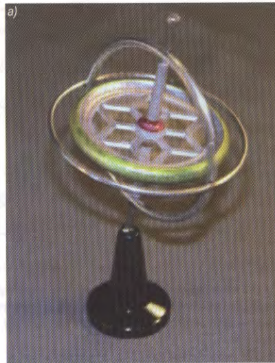
Rys. 8. Precesja giroskopu (czytaj: „żyroskop”), białą i poziomo zawieszoną kołem rowerowym; a) na giroskop, nieco pochylony, działa niezrównoważona siła grawitacji, powodująca precesję dookoła osi pionowej; kierunek precesji zależy od kierunku wirowania giroskopu; b) i c) oś rozkręconego koła wychylamy od pozycji poziomej za pomocą przeciwwagi – całe koło z osią zaczyna się powoli obracać w poziomie (fot. K.S.)
