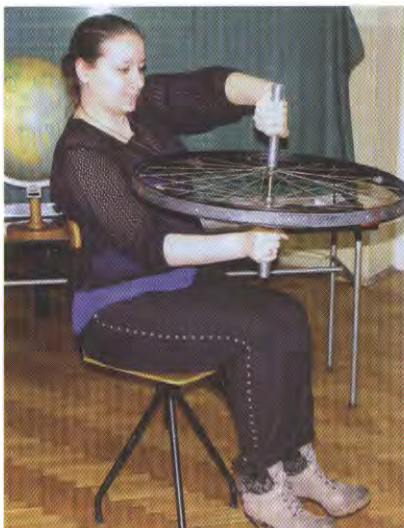
Rys. 6. Sumowanie momentów pędu na obrotowym krześle. Uwaga – doświadczenie bardzo niebezpieczne; uczeń powinien stabilnie siedzieć na krześle, dociskając łądźwie do oparcia, aby uniknąć upadku (fot. K.S.)
