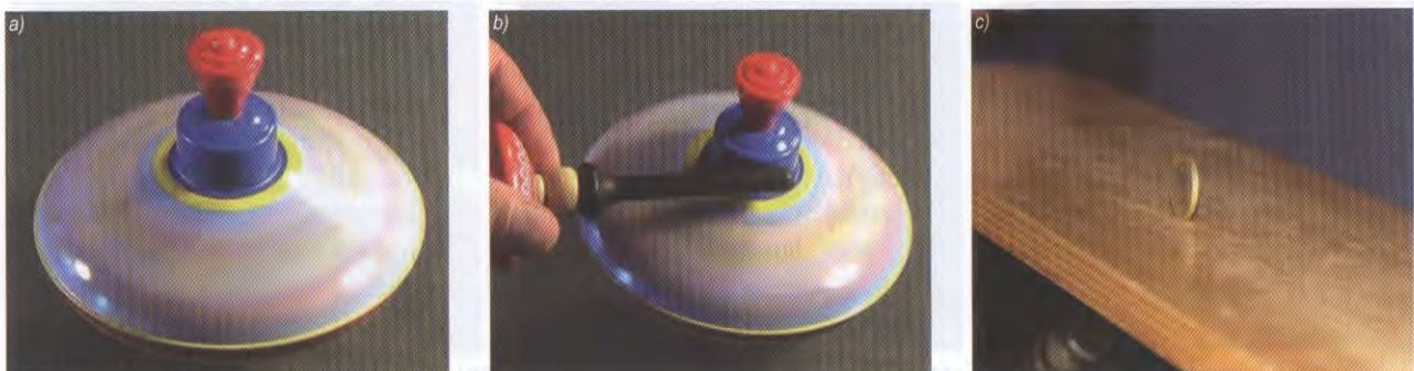
Rys. 1. Kręcące się obiekty zachowują kierunek wirowania – mówimy o zachowaniu momentu pędu: a) duży, energicznie rozkręcony bąk stoi idealnie pionowo; b) popchnięty „do tyłu” odchyła się w prawo, zgodnie z równaniem (8); c) moneta tocząca się po równi pochyłej również się nie przewraca; przechylona „zakręca” w kierunku przechylenia (fot. K.S.)
