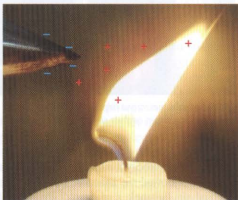
Fot. 11. Badanie właściwości płomienia świecy w pobliżu ostrza połączonego do ujemnego bieguna maszyny elektrostatycznej a) w słabym polu, b) w silnym polu
