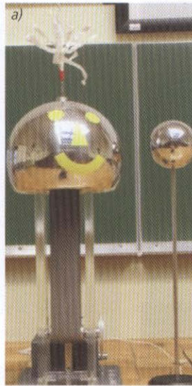
Fot. 4. a) Generator van der Graffa; b) układ linii pola elektrycznego wytworzonego przez generator
