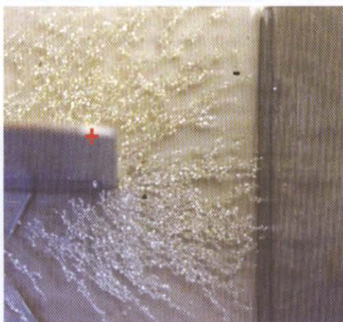
Fot. 7. Kształt pola elektrostatycznego między płytką (z prawej strony) a krawędzią drugiej płytki, ustawionej prostopadle. Największą koncentrację linii obserwujemy na brzegu lewej płytki, podobnie jak na ostrzu. Polaryzacja elektrod nie ma znaczenia dla obserwowanego rozkładu pola, inaczej niż w wyładowaniu w gazach
