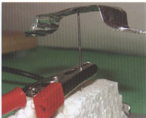
Fot. 9. Młynek Franklina zrobiony z igły i kawałka aluminium. Ostre zakończenia młynka są odpychane przez jony w powietrzu. Kierunek obrotu młynka nie zależy od jego polaryzacji (dodatniej czy ujemnej)
