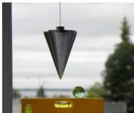
Fot. 1. (Pozioma) powierzchnia morza jest prostopadła do murarskiego „pionu”. Kulka położona na poziomej płaszczyźnie pozostaje w spoczynku. Pion wskazuje kierunek wypadkowej siły grawitacji i odśrodkowej siły bezwładności, a poziomica powierzchnię stałego potencjału grawitacyjnego (linia brzegowa w tle to port w Gdańsku, a czarny lewy margines to pionowa futryna okna)
