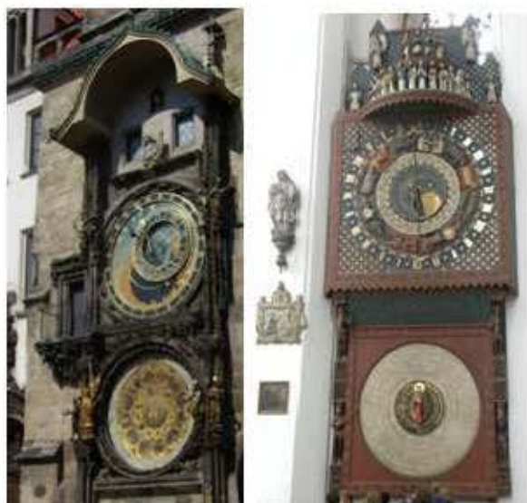
Fot. 2. Zegar astronomiczny z Pragi (1410/1490) i z Kościoła Mariackiego w Gdańsku (1470, Hans Düringer). Zegary budowane przed odkryciem przez Galileusza izochronizmu wahadła matematycznego dokładne być nie mogły. Zegar w Gdańsku zrekonstruowany dzięki długim staraniom prof. fizyki Politechniki Gdańskiej Andrzeja Januszajtisa
