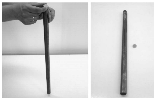
Rys. 3. Po lewej: magnes neodymowy i miedziana rurka bez podłużnych szczelin, po prawej: rurka miedziana z podłużnymi szczelinami.
