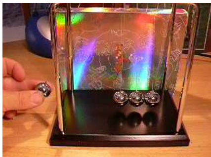
Fot. 5.3. W zabawce zwanej wahadłem Newtona, tyle kulek się odbije, ile zostanie spuszczonej po przeciwnej stronie. Aby to wyjaśnić, musimy skorzystać z prawa zachowania: energii i pędu http://dydaktyka.fizyka.umk.pl/zabawki1/files/mech/wahnewt-pl.html
