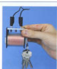
Spule mit Eisenkern als Elektromagnet
