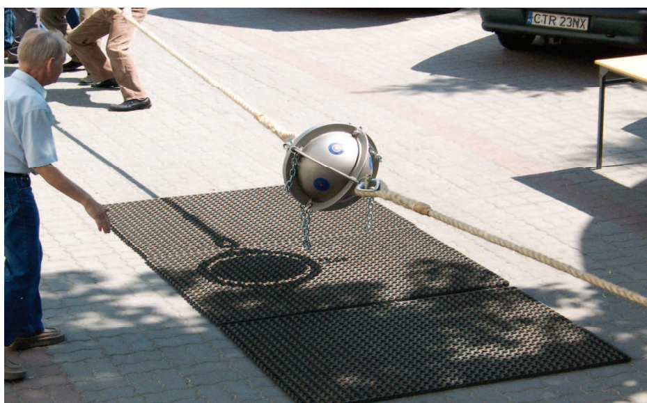
Fot. 4.5. Dwie identyczne siły ciągną półkule magdeburskie w przeciwnych kierunkach. Na punkt środkowy działa wypadkowa siła równa zero – pozostaje on w spoczynku
