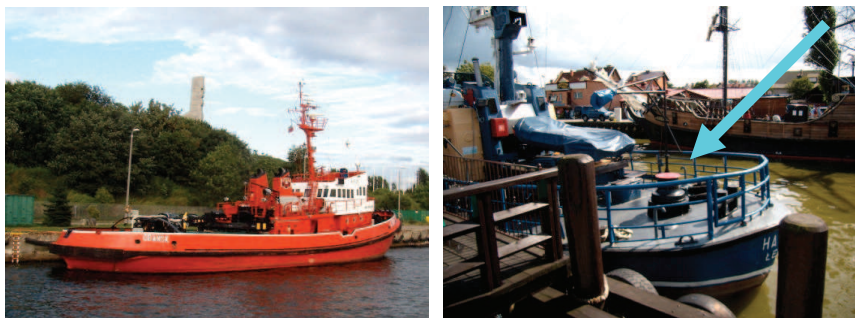
Fot. 4.10. Holowniki – na rufie każdego z nich widoczny zaczep do liny ciągnącej statek
