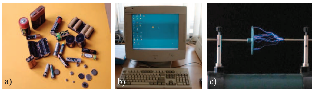
Fot. 1.13. a) Źródłem prądu z baterijki są przepływające elektrony ; b) takie same elektrony kreślą obraz w monitorze komputerowym; c) w wyładowaniu elektrycznym (iskrze) przepływające elektrony powodują świecenie gazu, podobnie jest w zorzy polarnej
