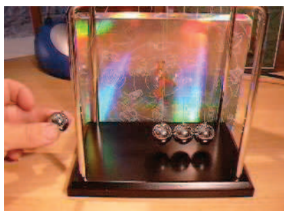
Fot. 5.3. W zabawce zwanej wahadłem Newtona, tyle kulek się odbije, ile zostanie spuszczonej po przeciwnej stronie. Aby to wyjaśnić, musimy skorzystać z prawa zachowania: energii i pędu http://dydaktyka.fizyka.umk.pl/zabawki1/files/mech/wahnemt-pl.html
