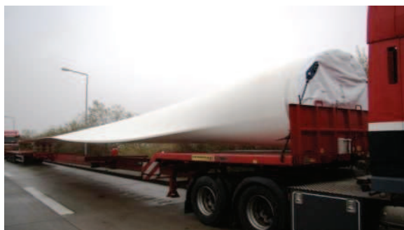
Fot. 3.16. Pojedyncze skrzydło wiatraka (elektrowni wiatrowej) ma długość 20 metrów, a nawet więcej. Skrzydło zamontowane na wiatraku porusza się z małą prędkością kątowną, ale jego koniec z dużą prędkością liniową
