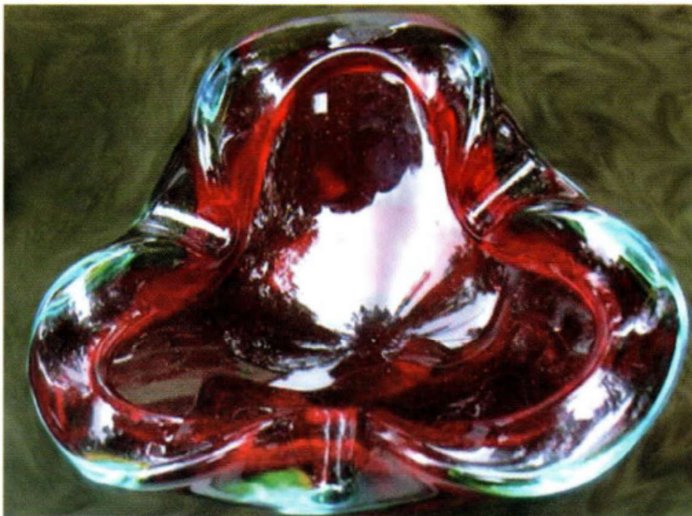
Fot. 12. Szkło „plazmonowe” – szkło z dodatkiem nanowtrąceń złota. Jest ono czerwone w świetle przechodzącym, a niebieskawe w wewnętrznych odbiciach. Źródłem niebieskiej barwy są plazmony, kolektywne wzbudzenia elektronów w nanowtrąceniach złota. Materiał ten, wynaleziony w Berlinie w XVII wieku, jest rodem z wieku XXI (zbiory autora)
