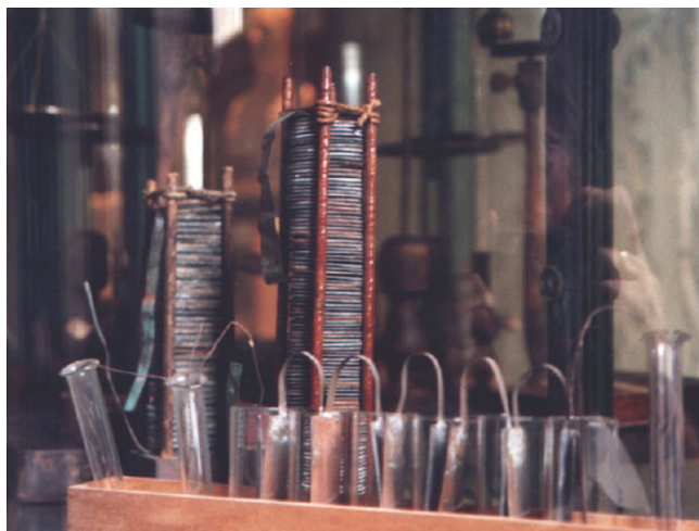
Fot. 11.1. Stos (z monet) Volty i bateria ze szklankami, Mauzoleum Volty, Como, fot. G.K.
