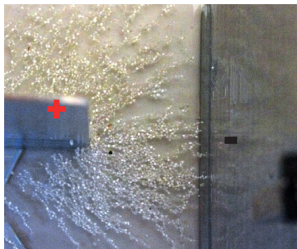
Fot. 7. Kształt pola elektrostatycznego między płytką (z prawej strony) a krawędzią drugiej płytki, ustawionej prostopadle. Największą koncentrację linii obserwujemy na brzegu lewej płytki, podobnie jak na ostrzu. Polaryzacja elektrod nie ma znaczenia dla obserwowanego rozkładu pola, inaczej niż w wyładowaniu w gazach
