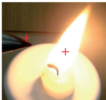
Fot.10. Płomień świecy w pobliżu ostrza podłączonego do dodatniego bieguna maszyny elektrostatycznej.
