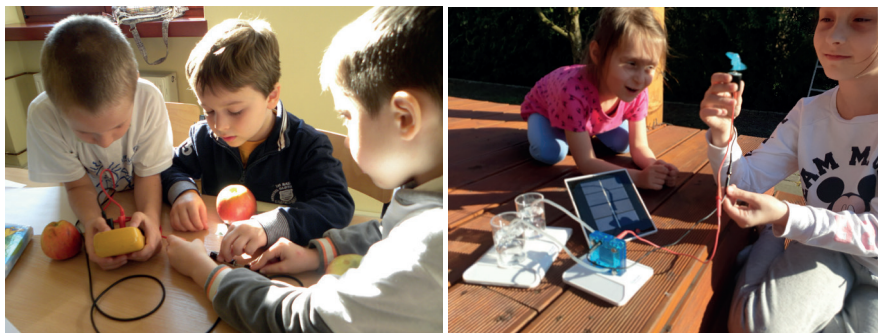
Ryc. 7a) Płytki aluminiowa i miedziana włożone do jabłka „dają” różnicę potencjałów (warsztaty Uniwersytetu Dziecięcego w Głogowie, 2011, fot. Maria Karwasz); b) miłe zaskoczenie, gdy z wodoru i tlenu można zasilić ogniwo paliwowe, a z powstałego prądu mały wiatraczek (fot. KW).
