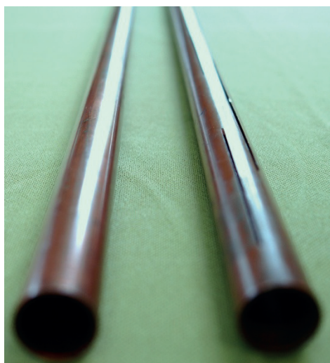
Ryc. 13. Zestaw dwóch rurek do ilustracji wpływu drogi całkowania pola elektrycznego w III równaniu Maxwella: jedna pełna, druga nacięta wąskimi szczelinami, częściowo na siebie zachodzącymi (C) GK
