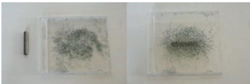
Fot. 2.1. Magnes i opiłki. Badanie pola magnetycznego za pomocą opiłków
