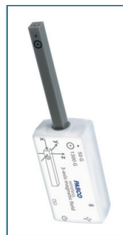
Fot. 12.2. (a) System Pasco do pomiarów pola magnetycznego (UMK): w lewym rogu cylinder z Fe, w środku (biały) cylinder z mumetalu oraz niezbyt silne, szkolne magnesy. (b) Bezprzewodowa sonda 3D Pasco: wzdłuż sondy zakres 50 G (=5mT), w poprzek 1300 G
