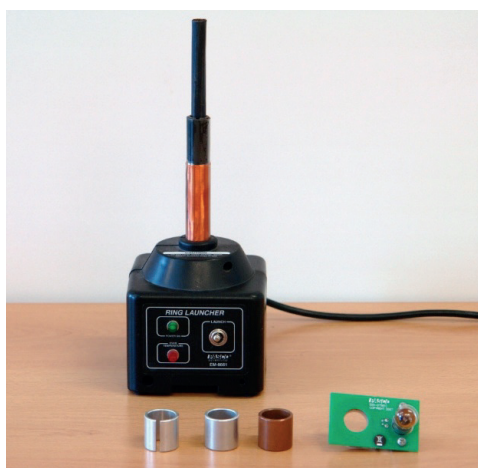
Ryc. 14. Działo Faradaya-Lenza: zmienne pole magnetyczne generowane przez miedzianą cewkę dookoła żelaznego rdzenia działa jak wyrzutnia – aluminiowy pierścień nanizany na ten rdzeń, po włączeniu przełącznika nagle wyskakuje w górę. Efekt nie pojawia się, jeśli pierścień jest przecięty. Mała cewka nanizana na rdzeń „wytłapuje” zmiany pola magnetycznego w rdzeniu, a podłączona do niej żaróweczka jarzy się
