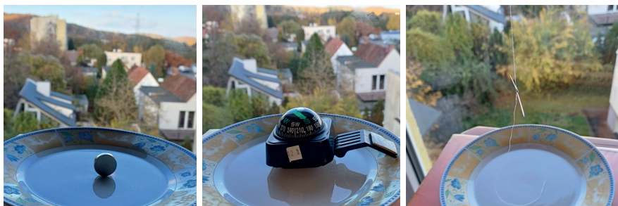
Fot. 12.1. Jakościowe pomiary pola magnetycznego Ziemi: (a) magnes neodymowy, (b) kompas 3D, (c) dwie sklezione i namagnesowane igły do szycia. Zdjęcie z okna w Sopocie, na północ – Gdynia
