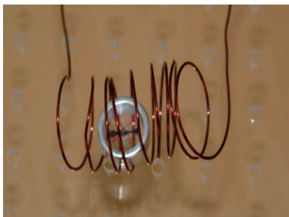
Fot. 5.7. Ustawienie zestawu do demonstracji powstawania pola magnetycznego wewnątrz solenoidu
