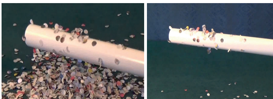
Fot. 10.2. Cekiny „przykleiły się” do naładowanej rurki
