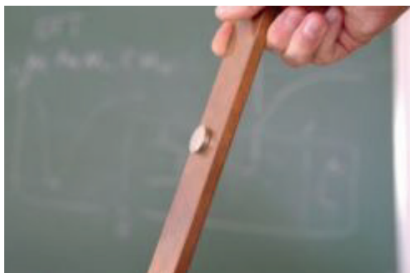
Ryc. 8. Neodymowy magnes zsuwający się po miedzianej równi
