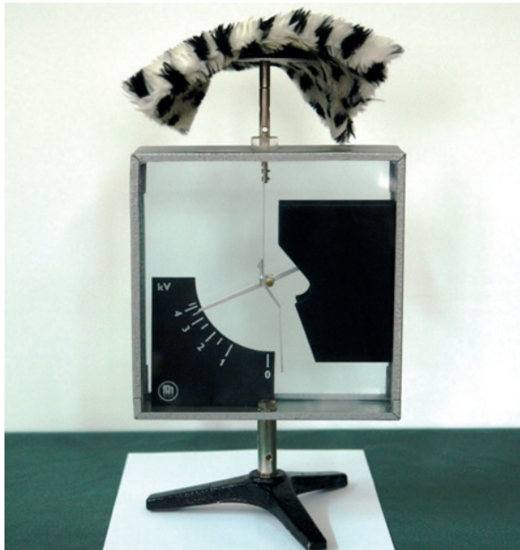
Fot. 10.3. Naładowane „futerko” na płycie elektroskopu
