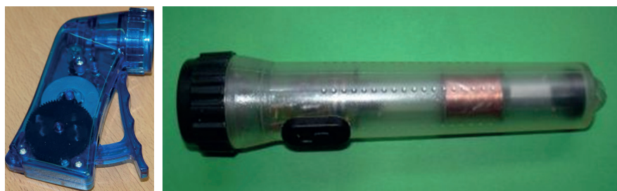
Fot. 8.1. Latarka „dynamo”: (a) z obracającym się magnesem, (b) z przesuwającym się magnesem
