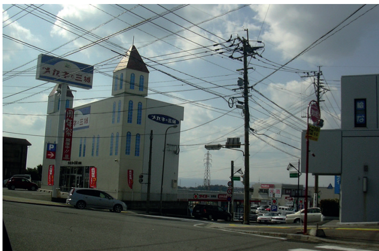
Fot. 9.3. Japońskie skrzyżowanie: plątana grubych kabli wynika z użycia niższego niż w Europie napięcia sieci miejskiej (110 V). Podobne obrazy zobaczysz w Australii i USA (fot. Maria Karwasz)
