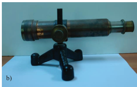
Ryc. 2.16. a) Spektroskop Kirchhoffa (źródło: Krüss Optronics); b) spektroskop służy do otrzymywania i analizowania widm promieniowania świetlnego (od podczerwieni do nadfioletu); składa się z poziomej tarczy z podziałką kątową, w środku której umieszczony jest pryzmat, lunety obracanej wokół tarczy oraz kolimatora wyposażonego w źródło światła (UMK, fot. A.K.)
