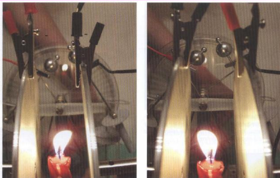
Fot. 8. Świeca umieszczona między metalowymi płytami w jednorodnym polu elektrycznym, w przypadku dwu różnych polaryzacji – płomień odchyła się zawsze w kierunku elektrody ujemnej
