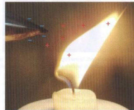
Fot. 11. Badanie właściwości płomienia świecy w pobliżu ostrza połączonego do ujemnego bieguna maszyny elektrostatycznej a) w słabym polu, b) w silnym polu
