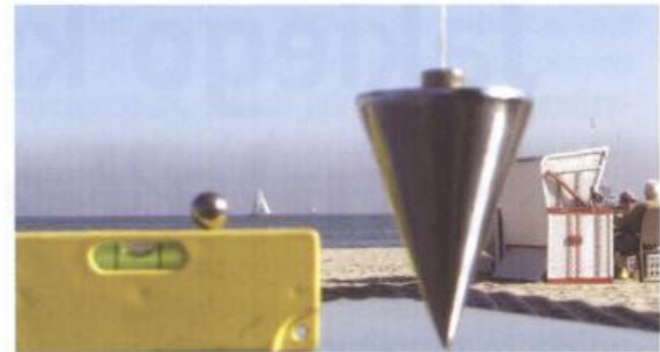
Fot. 2. Zawieszony „pion” wskazuje środek ciężkości Ziemi. Poziomica murarska wskazuje kierunek powierzchni morza, prostopadły do „pionu”. Kulka położona na poziomej powierzchni nie stacza się (fot. autor)
