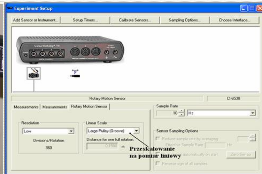
Rys.1.2. Widok ekranu monitora po zainstalowaniu czujnika siły i czujnika ruchu obrotowego przeskalanego na pomiar przemieszczenia liniowego.
