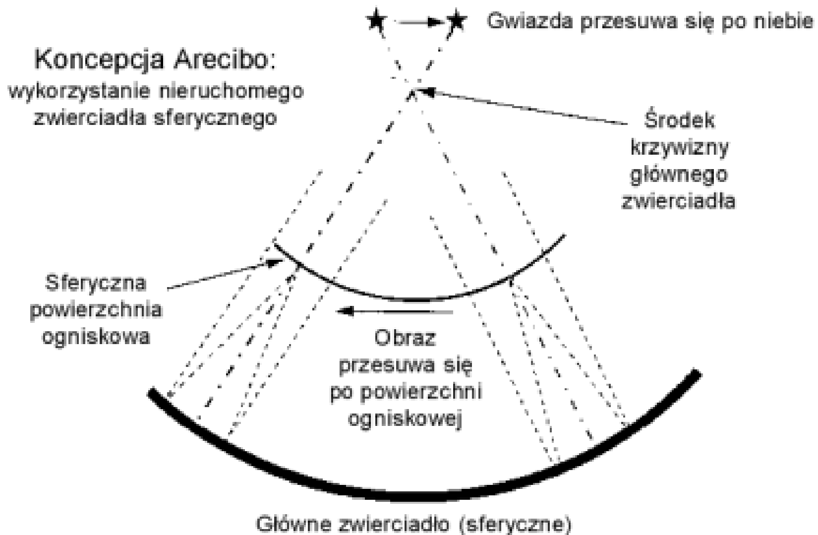
Rys. 1. Schemat zasady prowadzenia obserwacji teleskopem SALT
