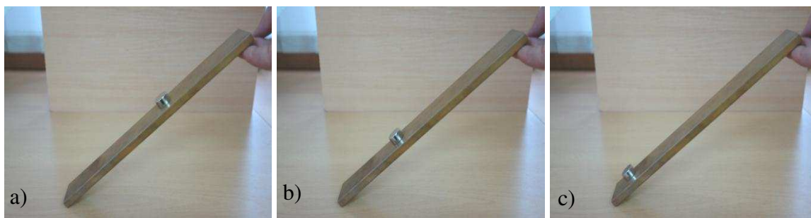
Rys. 2. Magnes neodymowy zsuwa się ruchem jednostajnym po miedzianej równi.
