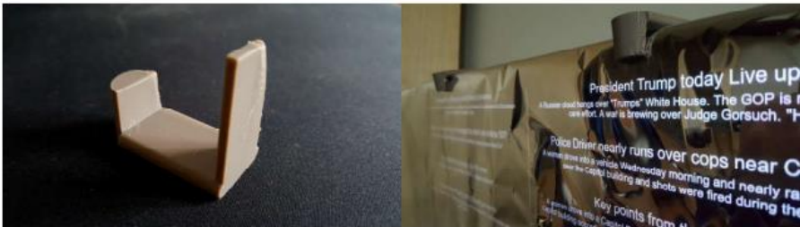
Rys. 5 – Klips wydrukowany w drukarce 3D Rys. 6 – Zamocowana folia z klipsami
