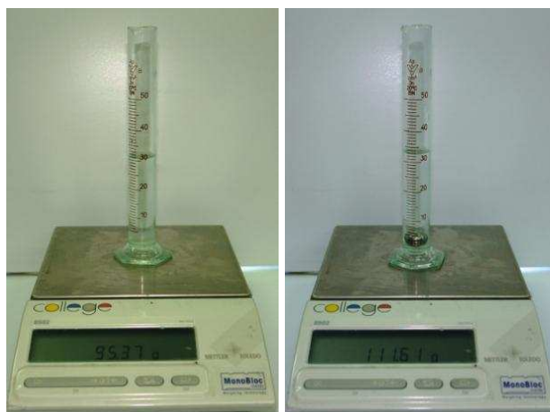
Fot. 2.9a Wyznaczania objętości: menzurka z podniesionym poziomem cieczy (po wrzuceniu badanego ciała do naczynia poziom wody podnosi się).
