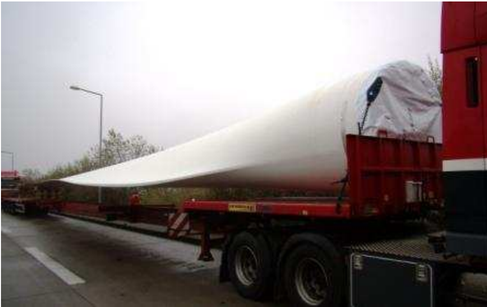
Fot. 3.16 Transport pojedynczego skrzydła wiatraka.
