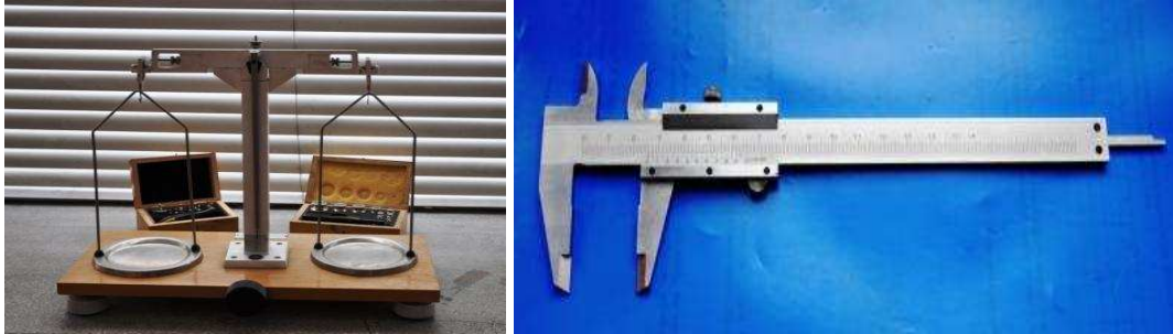
Fot. 2.10 Narzędzia potrzebne do wyznaczenia gęstości kawałka kredy szkolnej: a) waga szalkowa; b) suwmiarka
