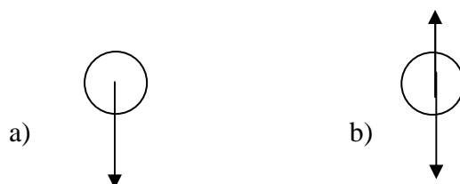
Rys. 4.1. Spadanie swobodne (a) i z uwzględnieniem oporu powietrza (b). Strzałki oznaczają działające na ciało siły.
