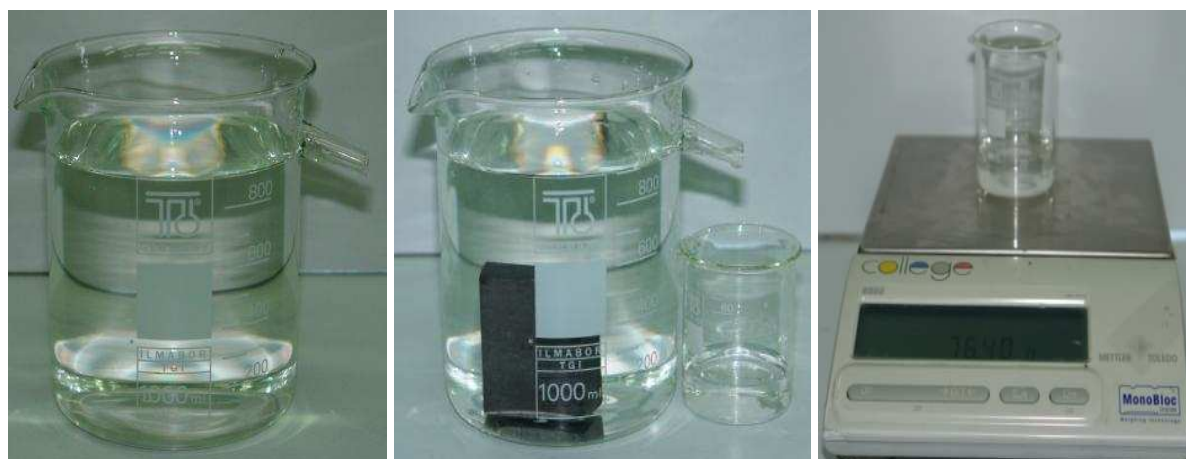
Fot. 2.9b Wyznaczanie objętości: menzurka, z której wylała się woda (po wrzuceniu badanego ciała do naczynia, część wody wylała się).
