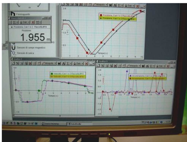
Fot. 1. Komputerowy pomiar położenia, prędkości i przyspieszenia. Ruch wózka w teorii jednostajny – linia „prawie” prosta na wykresie s(t) , górny panel, jest spowalniany przez tarcie, co wyraźnie widać na wykresie v(t) – lewy dolny panel. „Pomiar” przyspieszenia (dolny prawy panel) jako drugiej pochodnej położenia jest obciążony poważnymi błędami – pojawiają się dodatkowe piki, wynikające z błędów próbkowania.
