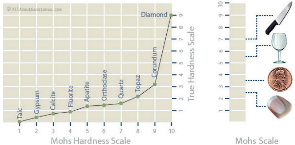
Rys. 3. Bardzo użyteczna, względna skala twardości Mohsa: materiał twardszy zostawia rysę na materiale miększym: twarda stal rysuje szkło a piasek (kwarc) rysuje stal. Paznokieć ma twardość ok. 2,5, czyli można nim zarysować gipsową ścianę, miedz ma 3,5, szkło 5,5, pilnik do paznokci ok. 6,5. (AllAboutGemstones.com, dostęp 2012)
