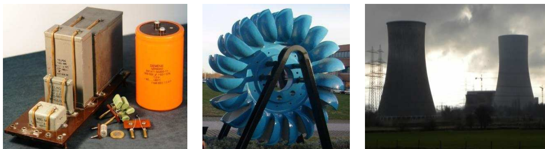
Fot. 2.6 Przedrostki jednostek miar pozwalają w skrótowy sposób charakteryzować szeroki zakres wielkości fizycznych a) „pojemność” kondensatorów zmienia się od piko przez nano do mikro ; b) moc małej turbiny wodnej (wysokości człowieka) to 1 MW; c) moc jednego reaktora w elektrowni atomowej to typowo 1 GW.
