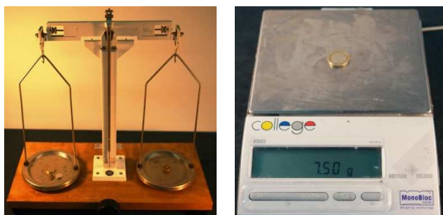
Fot.2.8 Rodzaje wag: a) szalkowa; b) elektroniczna
