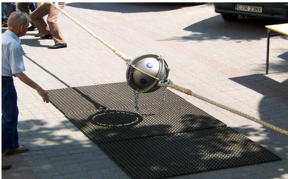
Fot. 4.4 Dwie identyczne siły ciągną półkule magdeburskie w przeciwnych kierunkach. Na punkt środkowy działa wypadkowa siła równa zero – pozostaje on w spoczynku.
