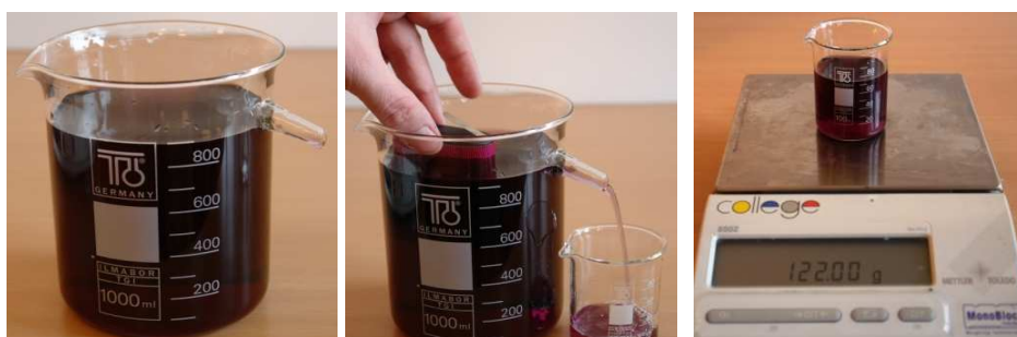
Fot. 2.10 Wyznaczanie objętości: menzurka, z której wylała się woda (po wrzuceniu badanego ciała do naczynia, część wody wylała się).
