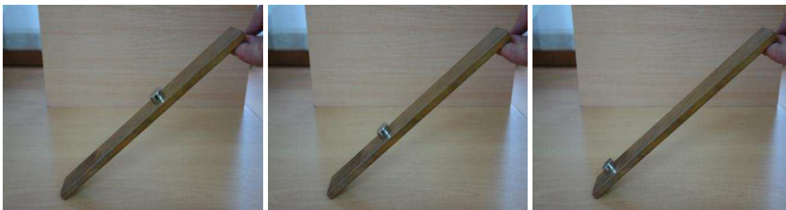
Fot. 3.5 Ruchem jednostajnym zsuwa się też neodymowy magnes po miedzianej płycie.
