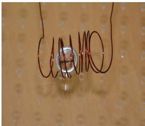
Zdjęcie 14. Ustawienie zestawu do demonstracji powstawania pola magnetycznego wewnątrz solenoidu.
