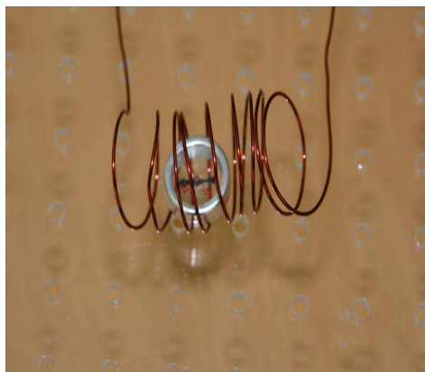
Zdjęcie 17. Ustawienie zestawu do demonstracji powstawania pola magnetycznego wewnątrz solenoidu.
