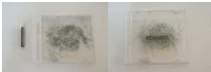
Zdjęcie 4. Magnes i opiłki. Badanie pola magnetycznego za pomocą opiłków.
