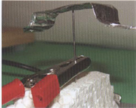
Fot. 9. Młynek Franklina zrobiony z igły i kawałka aluminium. Ostre zakończenia młynka są odpychane przez jony w powietrzu. Kierunek obrotu młynka nie zależy od jego polaryzacji (dodatniej czy ujemnej)
