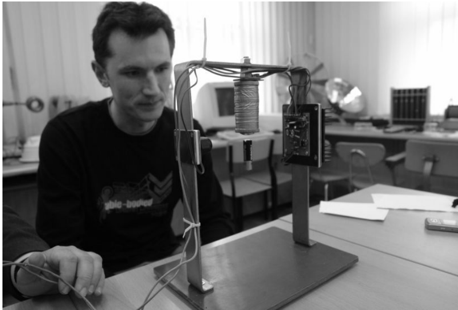
Rysunek nr 5: Lewitujący przedmiot – bateria R6.
