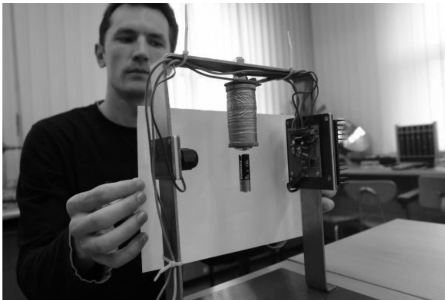
Rysunek nr 4: Lewitujący przedmiot – bateria R6.
