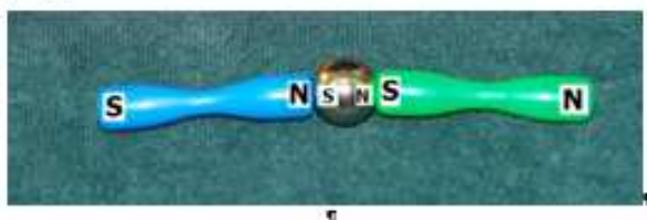
Rysunek 2. Pręciki magnetyczne zbliżone biegunami różnoimiennymi oraz indukowane pole magnetyczne w kulce.
