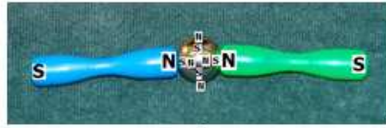
Rysunek 3. Pręciki magnetyczne zbliżone biegunami jednoimiennymi oraz indukowane pole magnetyczne w kulce.
