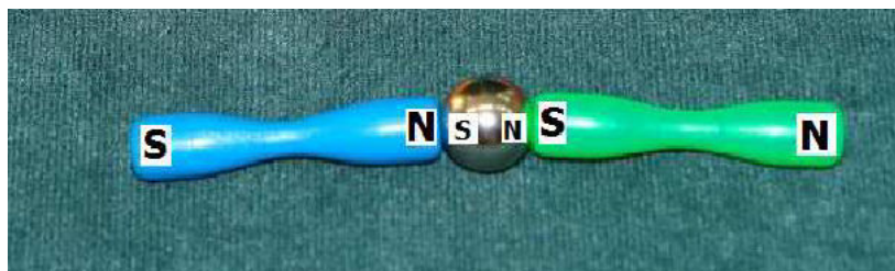
Rys. 27. Pręciki magnetyczne zbliżone biegunami różnoimiennymi oraz indukowane pole magnetyczne w kulce.
