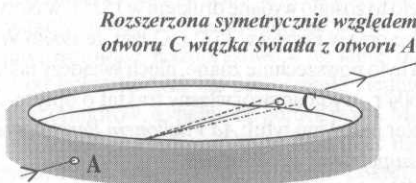
Rys. 11. Zasada dowodzenia prostoliniowego biegu światła.
