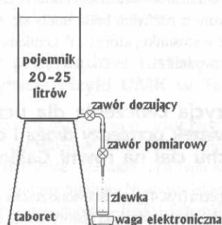
Rys. 5. Schemat współczesnego zegara wodnego.
