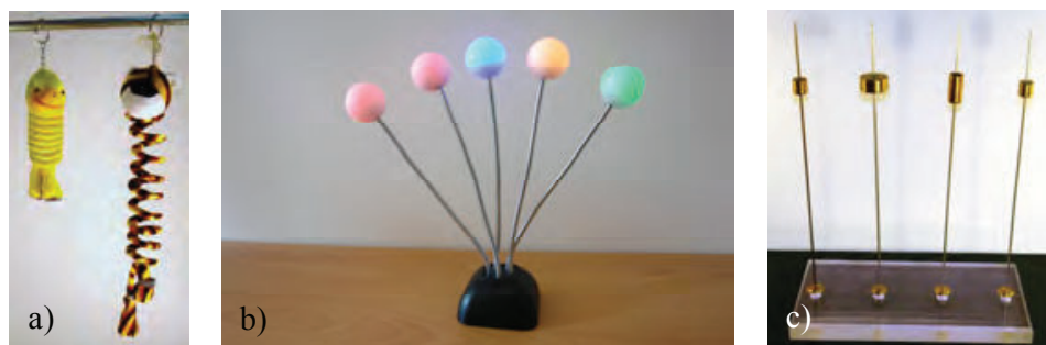
Fot. 4.12. Proste eksponaty do ilustracji ruchu drgającego: a) dwa bliźniacze eksponaty do zabawy „Dlaczego tygrys nie dogoni kurczaka?” – kurczak i tygrys z nogami na sprężynkach; tygrys dodatkowo obciążony „skarpetkami” z ółowiu; b) eksponaty do „ważenia” bez wagi, czyli do określania masy bez korzystania z prawa grawitacji – sprężyny zostały pieczołowicie wybrane spośród kilkunastu, tak aby miały ten sam okres drgań, dzięki temu mogą służyć do „ważenia”; c) ta sama idea co poprzednio, ale w eksponacie zaprojektowanym ab initio – walce o różnych rozmiarach mają okresy drgań mające się do siebie jak 1 : 2 (eksponaty i autor ścieżki GK, fot. KS)
