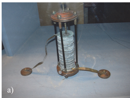
Fot. 2.3. a) Ogniwo Volty: ogniwo zbudowane z monet cynowych i srebrnych przekładanych kartonem nasączonym wodą, Como; b) schemat samochodowego akumulatora ołowiowego.
