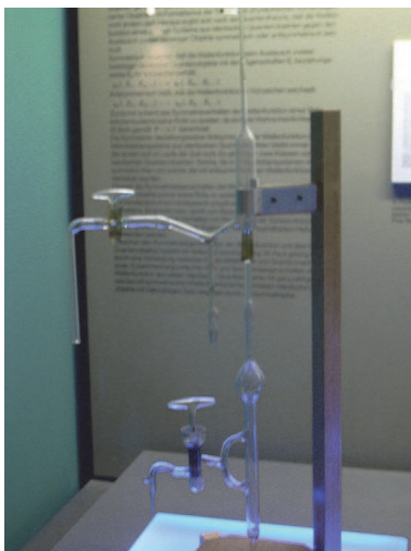
Fot. 3.5. Dwa epokowe doświadczenia z końca XIX wieku w Deutsches Museum w Monachium: a) E. Rutherforda, pokazujące że w rozpadzie polonu powstaje hel (kopia); b) J. J. Thompsona, odkrycie elektronu, odchylenie promieni katodowych przez pole elektryczne i magnetyczne (oryginał)
