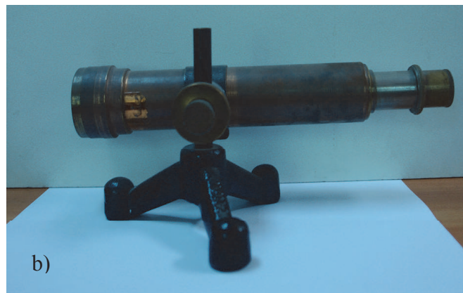
Ryc. 2.16. a) Spektroskop Kirchhoffa; b) spektroskop służy do otrzymywania i analizowania widm promieniowania świetlnego (od podczerwieni do nadfioletu); składa się z poziomej tarczy z podziałką kątową, w środku której umieszczony jest pryzmat, lunety obracanej wokół tarczy oraz kolimatora, wyposażonego w źródło światła (foto AK)
