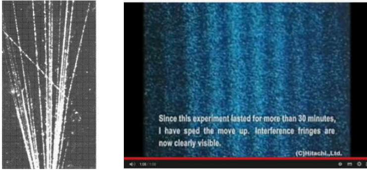
Ryc. 3.13. (a) Obiekty mikrokosmosu w skali makro zachowują się jak obiekty klasyczne: w komorze "bąbelkowej" cząstka alfa (2 neutrony + 2 protony) uderza w (lżejszy) proton w atomie wodoru: kąt uderzenia jest ostry. Zdjęcie pokazuje również zasadę Heisenberga; ślady nie są ciągłe: tam, gdzie jest punkt, cząstka alfa uderzyła w jakiś elektron (wtedy jej pozycja jest dobrze określona), ale nie znamy kierunku i prędkości cząstki; pomiędzy dwoma punktami możemy wydedukować prędkość, ale nie znamy pozycji pośrodku. (b) Obiekty mikrokosmosu zachowują się jak fale: wiązka elektronów przechodzi przez dwie bardzo wąskie szczeliny (zbudowane z potencjału elektrycznego). Pomimo faktu, że elektrony przechodzą jeden po drugim, na ekranie powstaje obraz "falowy", tak jakby następny elektron wiedział, gdzie spadł poprzedni. Oczywiście elektron nie "wie", że rządzi nim równanie wymyślone przez Schrödingera. ŹRÓDŁO: H. HAKEN, H.C. WOLF, Atoms and quanta ; HITACHI LTD. (Youtube).
