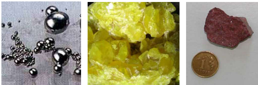
Ryc. 3.5. Związki atomów mogą mieć właściwości fizyczne bardzo różne od ich składników. a) Rtęć, Hg, metal ciężki, jest cieczą w temperaturze pokojowej; rozarta z siarką (b), tworzy szary proszek HgS; w postaci krystalicznej HgS jest minerałem zwanym cynobrem, jasnoczerwonym pigmentem (c). ŹRÓDŁO: AUTOR
