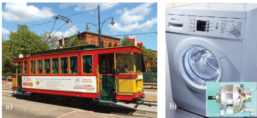
Ryc. 2.4. Zastosowania energii elektrycznej: a) toruński tramwaj z 1911 roku, obecnie turystyczny; b) silnik elektryczny pralki; pralka „zużywa” sporo energii elektrycznej – 2 kJ na sekundę, czyli ma moc 2 kW. Fot. Wikipedia (Mateuszgdynia); A. Kozłowska.
