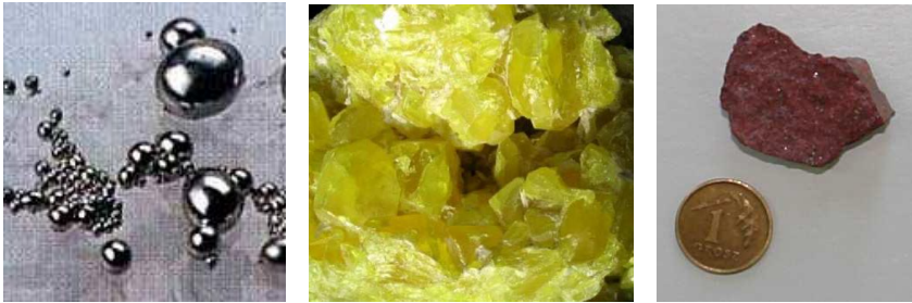
Ryc. 3.5. Związki atomów mogą mieć właściwości fizyczne bardzo różne od ich składników. a) Rtęć, Hg, metal ciężki, jest cieczą w temperaturze otoczenia: roztrąta z siarką (b), tworzy szary proszek HgS; w postaci krystalicznej HgS jest minerałem zwanym cynobrem, jasnoczerwonym pigmentem (c). ŹRÓDŁO: AUTOR
