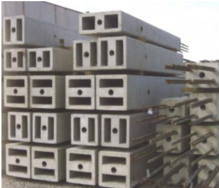
Stoccaggio di pilastri prefabbricati prima del loro montaggio
