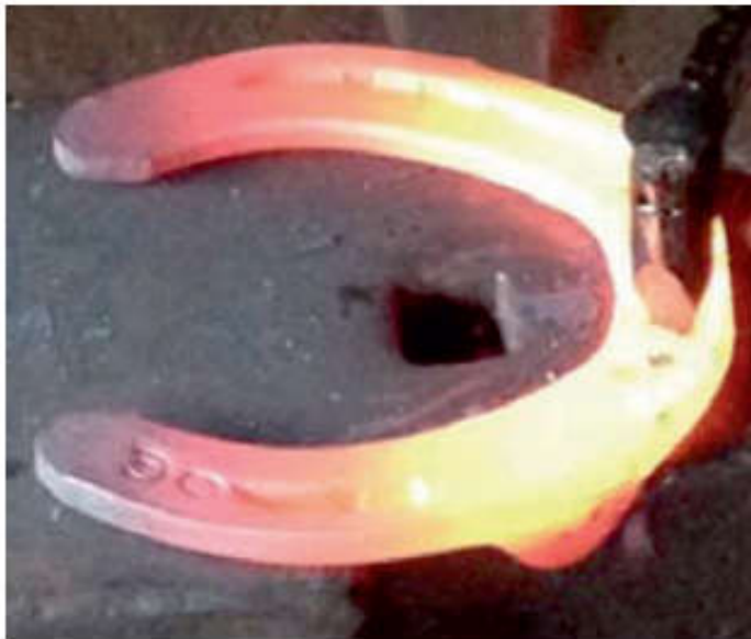
Figura 2.10. (a) Il colore del ferro da cavallo (e del filamento di una lampadina) cambia con la temperatura: da rosso (a 1000^{\circ}\text{C} ) a giallo fino a bianco incandescente a 3000^{\circ}\text{C} . (b) Nello stesso modo cambia anche il colore delle stelle: la Spica, con la superficie a 23000^{\circ}\text{C} sembra azzurra rispetto al Sole ( 5500^{\circ}\text{C} ) e alla grossa ma relativamente fredda Antares (nella cintura di Orione), che è rossa. FONTE: NURE AGLIO; ERIC C. BLACKMAN.
