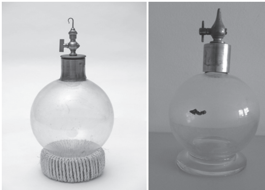
Obrázok 01 Aparatúra na klasické stanovenie molekulovej váhy. Na ľavej strane sa nachádza typická aparatúra z 19. storočia určená na stanovenie hustoty plynov pochádzajúca z Jansen Thomas Apparatus Collection (Oesper Collections), University of Cincinnati, 2015. Na pravej strane je podobná aparatúra zo zbierky autora state.
