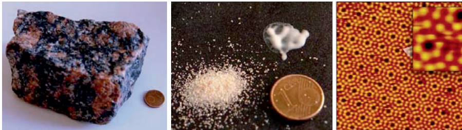
Figura 3.2. (a) Un pezzo di granito dalla Lettonia: si distinguono i grossi cristalli di ortoclasio (rosa), quarzo (bianchi) e mica (neri). (b) I cristalli bianchi nel pezzo di granito sono fatti di quarzo. Su questa foto certi cristalli hanno le dimensioni della sabbia, altri mille volte più piccoli (delle dimensioni di un micrometro) vengono usati per strofinare lo sporco ostile sulle superfici dure. (c) Dividendo questi ultimi altre mille volte si arriverebbe a singoli atomi, qui visibili tramite un microscopio “a forza atomica”: i punti bianchi sono gli atomi, mentre gli spazi neri indicano la loro assenza. FONTE: (a, b) Foto GK; (c) RHK Technology (2006), Dr. Xue Kun, Prof. Xu Jian Bin – The Chinese University of Hong Kong.
