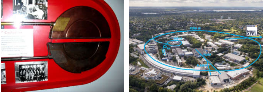
Ryc. 3.15. (a) Pierwszy akcelerator protonów, synchrotron (tutaj konstrukcja Cambridge) zajmował powierzchnię stołu. (b) Dzisiejsze akceleratory, takie jak synchrotron hamburski, mają rozmiary setek metrów, jeśli nie dziesiątek kilometrów, jak ten w CERN w Genewie. ŹRÓDŁO: GK; (C) DESY, Hamburg, 2015.
