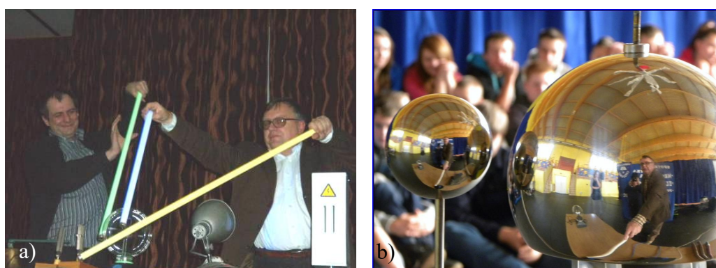
Fot. 4.19. „Niech to piorun trzaśnie!” – wykład interaktywny z elektryczności (ZDF UMK): a) kula plazmowa jako źródło fali powierzchniowej zapalającej lampy jarzeniowe; b) obsługa generatora van der Graafa wymaga szczególnej ostrożności – wytwarzane napięcia to setki tysięcy woltów (fot. MK)
