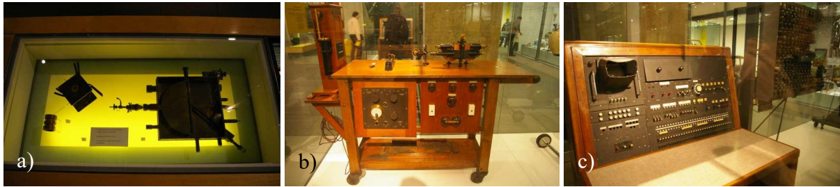
Fot. 6.16. Historia nauki i techniki w Science Museum: a) fizyka jądrowa: pierwszy 11-calowy cyklotron – urządzenie do przyspieszania protonów, E. Lawrence, 1932 r.; b) medycyna: pierwszy elektrokardiograf na kółkach, T. Lewis, 1930 r.; c) wojskowość: pierwszy radar (fot. ŁK)
