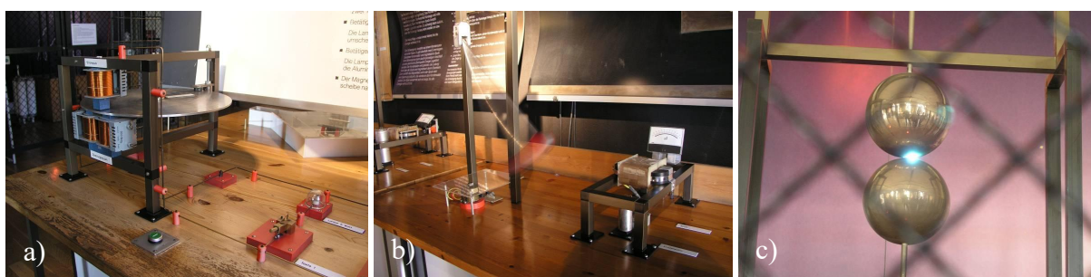
Fot. 6.42. Muzeum „Spectrum” w Berlinie: a) prądy wirowe, zastosowania praktyczne w liczniku prądu – zmienny prąd powoduje obracanie się tarczy; b) indukcja elektromagnetyczna – hamowanie aluminiowego wahadła w polu magnetycznym; c) wyładowania elektryczne między dwoma metalowymi kulami (fot. ŁK)
