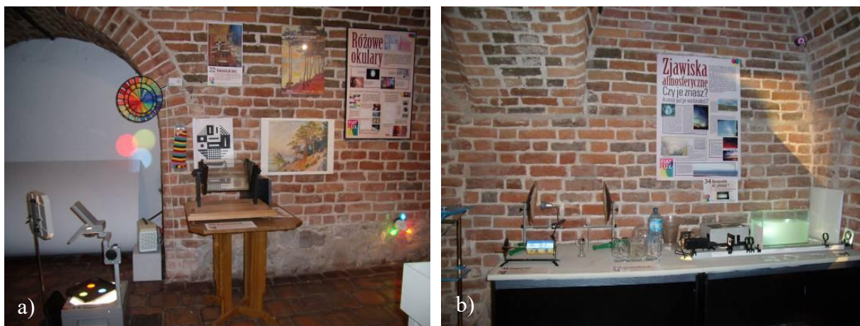
Fot. 7.12. „Fiat Lux! Od Witelona do tomografu optycznego” – interdyscyplinarne ścieżki dydaktyczne: a) pryzmat wodny Goethego z czarno-białymi figurami na ekranie obok obrazów impresjonistów i składania kolorów z rzutnika światła (zbiory PDF UMK); b) szkolna ława optyczna (funkcja dydaktyczna), zwierciadła, podczerwień (funkcja ludyczna) z przesłoną z krzemu (funkcja naukowa); plakat odnosi się do zjawisk atmosferycznych i pośrednio do dzieła Witelona (fot. MK)
