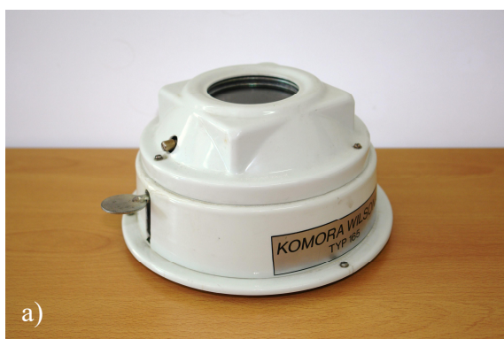
Fot. 7.29. Konstruowanie ścieżki dydaktyczno-naukowej współczesnej fizyki: a) dydaktyczna komora mgłowa Wilsona do obserwacji torów cząstek alfa (ZDF UMK) i b) doświadczenie interaktywne obserwacji ścieżek cząstek elementarnych, Deutsches Museum Berlin (fot. KS i ŁK)
