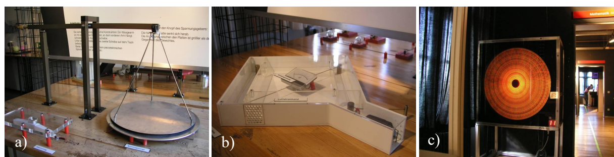
Fot. 6.44. Ekspozyty interaktywne w berlińskim Spectrum: a) waga elektrostyczna Volty – ekspozyt znajdujący się w wielu szkołach; b) zjawisko fotoelektryczne – pomiar za pomocą woltomierza analogowego (w środku układu); c) dynamiczne złudzenia optyczne, a w zasadzie obrazy stroboskopowe – układ diod luminescencyjnych zapalający się w określonych sekwencjach na wirującej tarczy, dający obraz gwiazdy, róży itp. (Fot. ŁK i GK)
