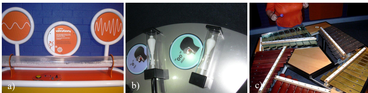
Fot. 5.8. Fale i akustyka w Questacon: a) fala stojąca w rurze z wodą, w zależności od regulowanej częstotliwości; b) samogłoski języka angielskiego artykułowane w sposób sztuczny przez przepływ powietrza wewnątrz profilowanej wnęki; podobne urządzenie zobaczymy w Spectrum w Berlinie, a dotyczy ono języka niemieckiego; c) kolekcja interaktywnych ksylofonów i cymbałów (fot. MK)
