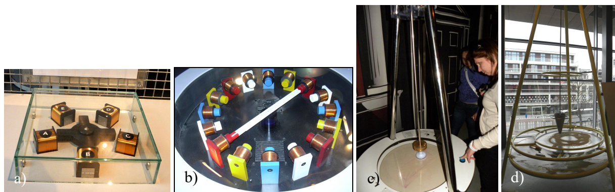
Fot. 8.28. Analogie w centrach nauki – silniki elektryczne: a) CNK silnik w pięcioma biegunami stojana i 4 biegunami wirnika; b) Cité des Sciences, Paryż, silnik wielobiegunowy (niestety, 6 stycznia 2005 zepsuty). Ten sam temat na dwa różne sposoby w CNK – figury Lissajoux: c) ślad drgań na ekranie światłoczułym; d) ślad w postaci strużki piasku (fot. GK)
