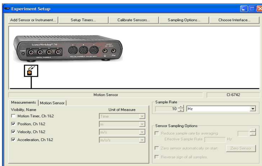
Rys. 2. Widok konsoli pomiarowej ScienceWorkShop 750 i podłączonego do niej ultradźwiękowego czujnika położenia w programie DataStudio.
