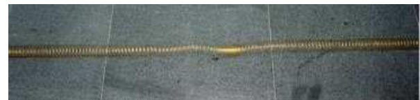
Fala podłużna rozchodząca się na sprężynie
