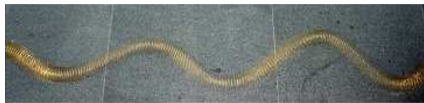
Fala poprzeczna rozchodząca się na sprężynie
