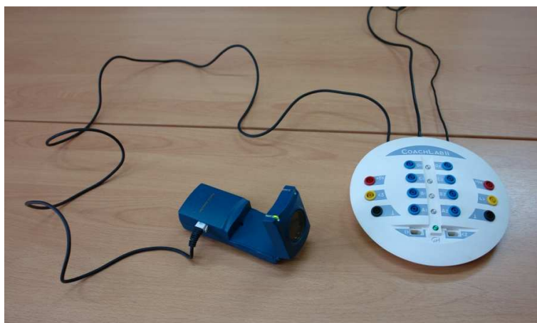
Rys. 1. Sposób podłączenia ultradźwiękowego czujnika położenia do konsoli pomiarowej Coachlab II (foto A. Karbowski).
