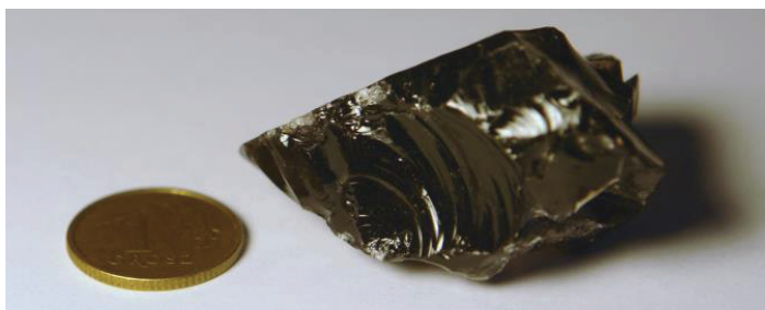
Ryc. 2.27. Krzem – szary i połyskujący metalicznie – jest nieprzezroczysty w świetle widzialnym. Fot. K. Służewski
