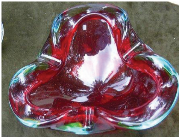
Ryc. 2.9. Waza według tajnej recepty z Berlina z XVIII wieku na produkcję szkła rubinowego; waza jest czerwona w świetle przechodzącym, ale z niebieskimi odcieniami po bokach; jest to przykład zjawisk kwantowych w absorpcji i emisji światła (eksponat i fot. G.K.)
