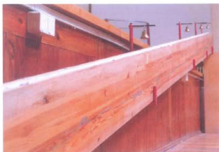
Fot. 1. Rekonstrukcja równi pochyłej Galileusza w pracowni Zakładu Dydaktyki Fizyki UMK, zob. [4]
