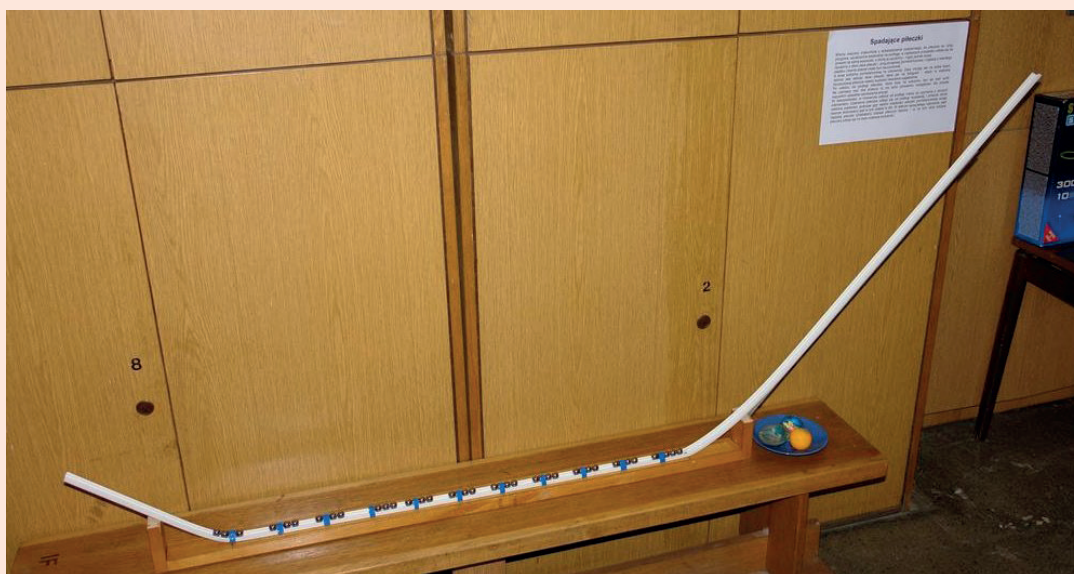
Ryc. 8. Proca magnetyczna: 10 magnesów neodymowych umocowanych na plastikowej szynie. Asymetryczna konfiguracja kulek (więcej po prawych stronach magnesów) jest niesymetryczna (wymaga precyzyjnego „naciągu”). Kulka spuszczone z lewej strony równi powoduje zaburzenie równowagi i w serii i- magnesów jedna kulka z prawej strony zostaje wystrzelona, jak w reakcji łańcuchowej, do magnesu na prawo. Kulka z ostatniego magnesu wznosi się po prawej stronie równi znacznie wyżej niż kulka, którą spuściliśmy z lewej strony. Ekspozycja ten to daleka analogia konstrukcji ADP/ATP: przyłączenie kolejnych grup fosforanowych to jak naciąganie kulek z prawych stron magnesów: tę energię można odzyskać w efekcie „procy”. Fragment wystawy „Z górki na pazurki, czyli wszystko o równi pochyłej Galileusza”, GK i współpracownicy, UMK, kwiecień 2007 [9].
