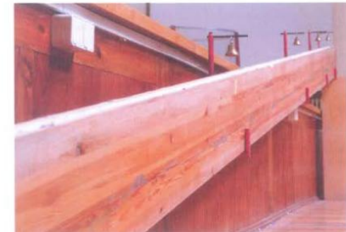
Fot. 1. Rekonstrukcja równi pochyłej Galileusza w pracowni Zakładu Dydaktyki Fizyki
